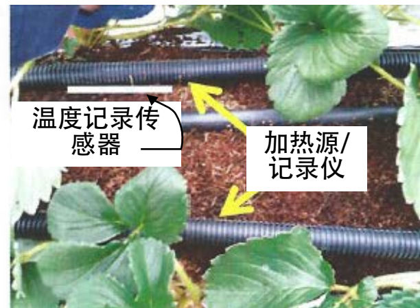
两条置于波纹管内的非晶态加热带
